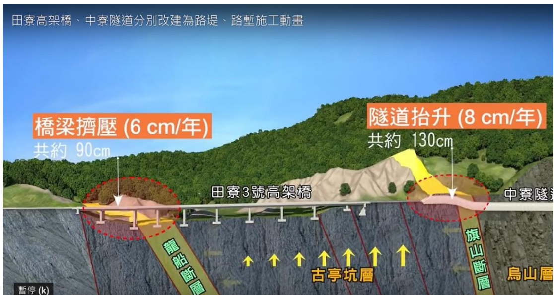
圖 2 標示有 8cm/年和 6cm/年上升量，龍船斷層應為車瓜林斷層，此圖亦可解釋為衝頂作用結果。(擷取自高公局網站)
